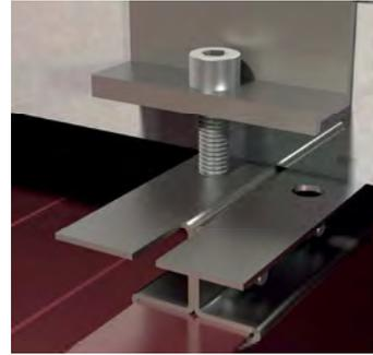
Il fissaggio è punto di forza del sistema **Dryfix™**, che permette di realizzare una copertura ventilata senza forare i pannelli coibentati metallici pur mantenendo caratteristiche meccaniche di adeguata resistenza alle sollecitazioni. **Dryfix™** (nome prodotto che si ispira alle sue proprietà: fissaggio asciutto e sicuro) senza fori passanti può collegare tegole, tavolati, listelli, pannelli solari termici o moduli fotovoltaici.
